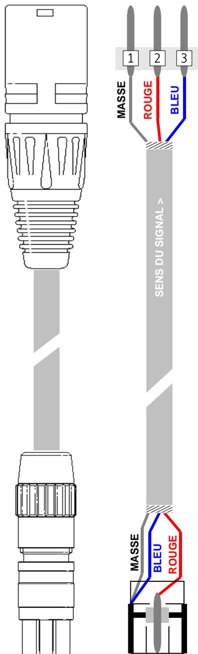
Les équipements professionnels disposent de connexions d'entrée et de sortie des signaux analogiques au standard symétrique. Ce choix est guidé par la nécessité de s'affranchir des bruits parasites qui peuvent être induits sur les câbles de liaison, soit par couplage capacitif, soit par couplage inductif.
